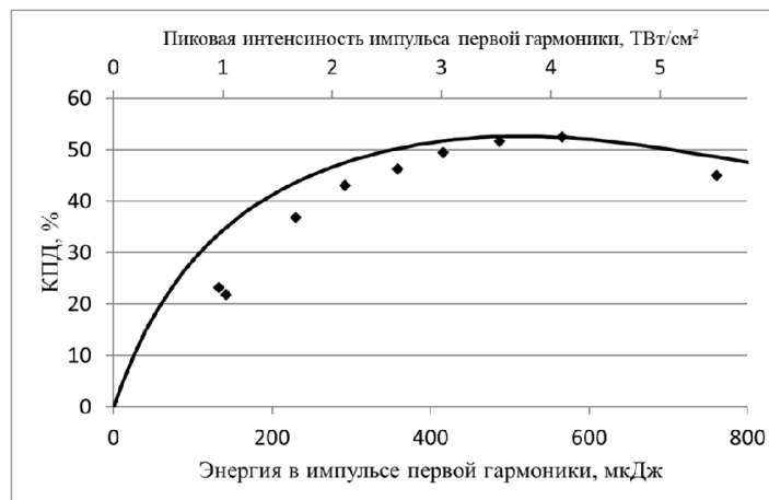
Рис. 34 Зависимость эффективности преобразования от энергии импульса первой гармоники точки – экспериментальные данные, сплошная линия результат численного моделирования с использованием поперечного распределения пучка из эксперимента.
